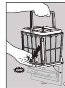
РИС. 6.1 — ИЗВЛЕЧЕНИЕ И ЧИСТКА ФИЛЬТРОВАЛЬНОЙ КОРЗИНЫ
