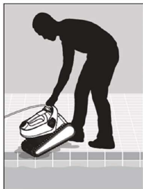
РИС. 5.3.3 — ИЗВЛЕЧЕНИЕ УСТРОЙСТВА ИЗ БАССЕЙНА
