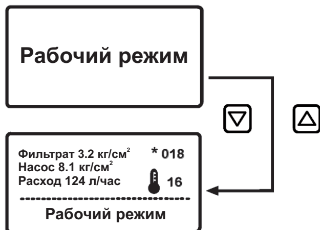
Рис. 5: Дисплей рабочего режима, сигнал давления отказа еще не получен.
