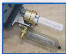
Для замены картриджа AQA nano достаточно отвинтить пластиковую колбу, извлечь старый картридж, вставить новый и установить колбу на место. Внизу колбы расположен штуцер для слива воды из установки
