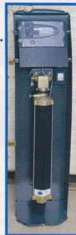
Передняя панель Aqua total легко снимается, открывая доступ к картриджу, который без труда заменяется благодаря байонетному соединению. Перед заменой давление внутри установки выравнивают, открыв специальный клапан на картридже
