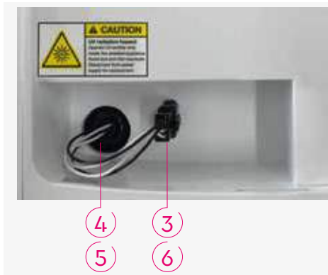
Рис. 12: Разъем УФ-лампы под крышкой AQA drink Pro 20
