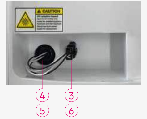
Fig. 12: Apertura della lampada UV sotto al coperchio dell'AQA drink Pro 20
