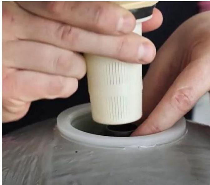
Аккуратно установить управляющий клапан с верхним распределительным устройством на водоподъемную трубу, слегка нажав на клапан сверху до исчезновения зазора между горловиной корпуса и резьбой корпуса клапана.
