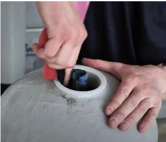
Вынуть воронку из горловины корпуса и пробку из водоподъемной трубы, придерживая ее рукой для предотвращения движения вверх. Вытереть остатки засыпки с резьбы горловины корпуса и с верхней части водоподъемной трубы.
