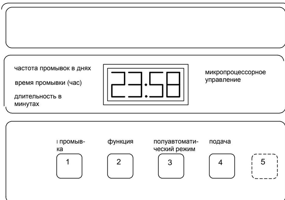
Автоматический пульт управления включает в себя жидкокристаллический экран и 5 клавиш управления:
