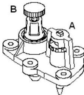
После регулировки полностью откройте несколько точек потребления воды (кранов) для достижения максимального расхода, и затем закрутите регулятор В, если остаточная жесткость выше требуемой, либо отверните его, если жесткость слишком низкая.
