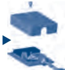
Вставьте новую батарею (CR2032) (немного надавите вниз). Соблюдайте полярность! Затем винтом на корпусе закрепите крышку.
