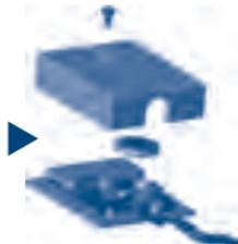
Снимите крышку, а затем разряженную батарею.
