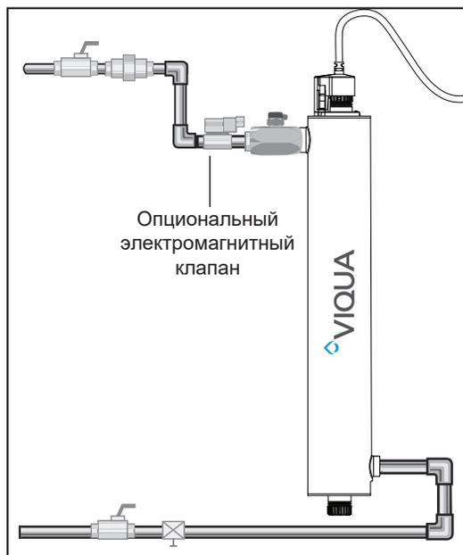
Рисунок 6 Установка электромагнитного клапана
