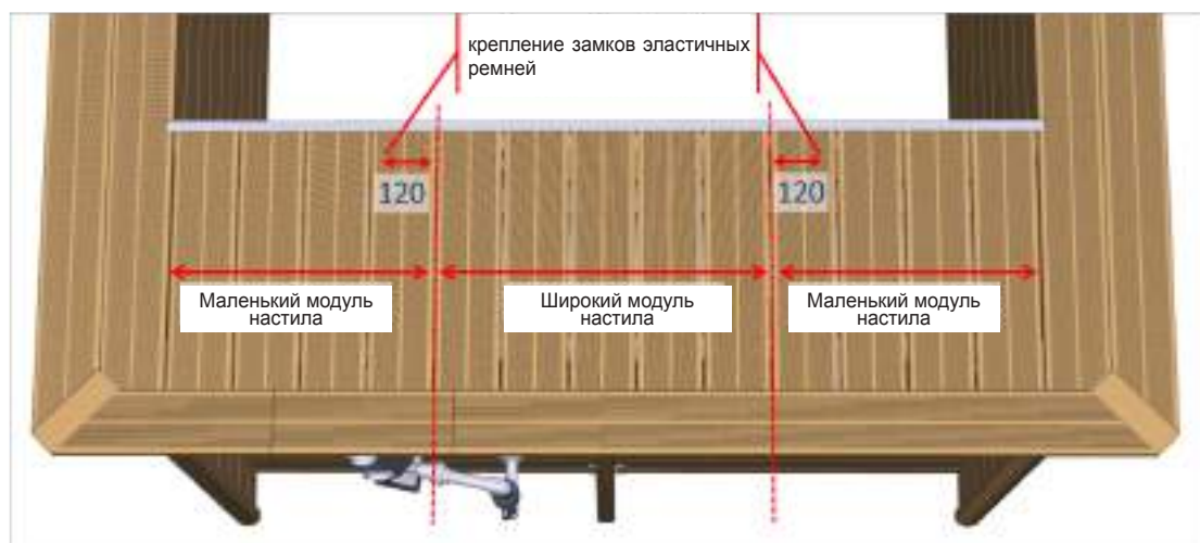
Рисунок 53 – Крепление эластичных ремней под решетками
