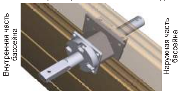
Рисунок 39 – Установка вала автоматического покрытия
