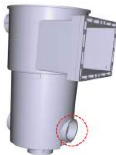
Рисунок 22 – Монтаж вставки-переходника на скиммер
