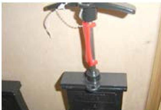
Убедитесь в том, что клапан слива воды самотеком закрыт (ручка перпендикулярна трубке) и крышка плотно навинчена на клапан. Примечание: герметичность обеспечивается уплотнением в нижней части крышки.
