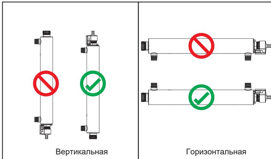
Рисунок 2 Установка системы обеззараживания - вертикальная и горизонтальная
