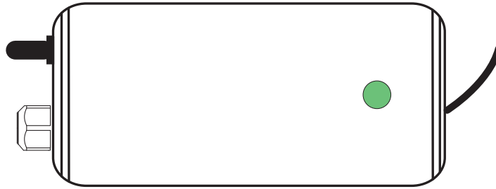
СИД зеленого цвета указывает на включенное состояние УФ-лампы.
