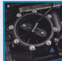
**Установки могут быть оборудованы счетчиками объема умягченной воды. На основе этой информации устройство рассчитывает время регенерации. Также предусмотрены модели без счетчика — они запускают регенерацию через заданные промежутки времени, по таймеру**
