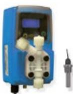
Электромагнитный насос с пропорциональным дозированием для активного кислорода. Регулятор Oxydose производит дозировку в зависимости от температуры воды и объема бассейна. Программируется, позволяет выбрать день и время обработки в зависимости от использования. Дезинфекция активным кислородом не подходит для общественных бассейнов. Кроме того, не рекомендуется для бассейнов, оборудованных диатомовыми фильтрами.
