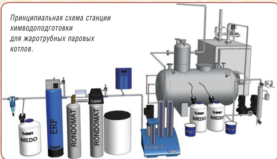
Принципиальная схема станции химводоподготовки для жаротрубных паровых котлов.
